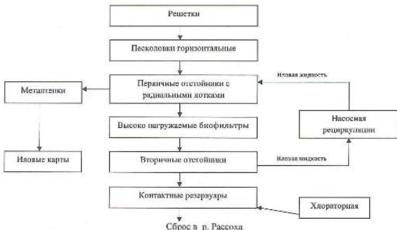
Рис. 3.2.1 — Схема канализационных очистных сооружений г. Железногорска-Илимского
